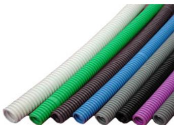
Гофротрубы ПВХ производятся в двух вариантах: с зондом (протяжкой) и без зонда. Протяжки используются для протягивания всех типов кабелей и проводов через гофрированные или гладкие жесткие трубы или по фальш-потолку/полу. Гофрированная труба с зондом имеют протяжку в виде стальной проволоки диаметром сечения от 0,8 до 1,0 мм, после протягивания кабеля проволока выбрасывается.
