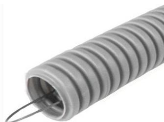
В случае если гофрированная труба без протяжки, или требуется провести замену проводов в трубе, существуют многоразовые протяжки (приобретаются отдельно) в виде стального троса или плоской ленты, а также из материала полиамид ПА66 и ПА12 (коммерческое название нейлон). Данные протяжки (зонды) предполагают многократное использование, что значительно экономит средства.
